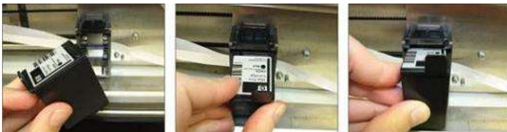
Pokazuje, jak włożyć wkład atramentowy.
