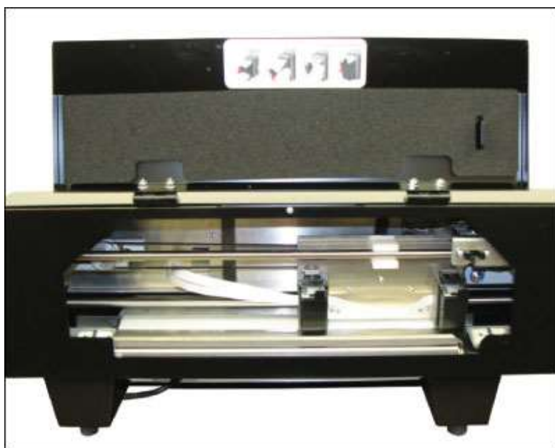
Pokazuje InkConnect z otwartą tylną pokrywą
