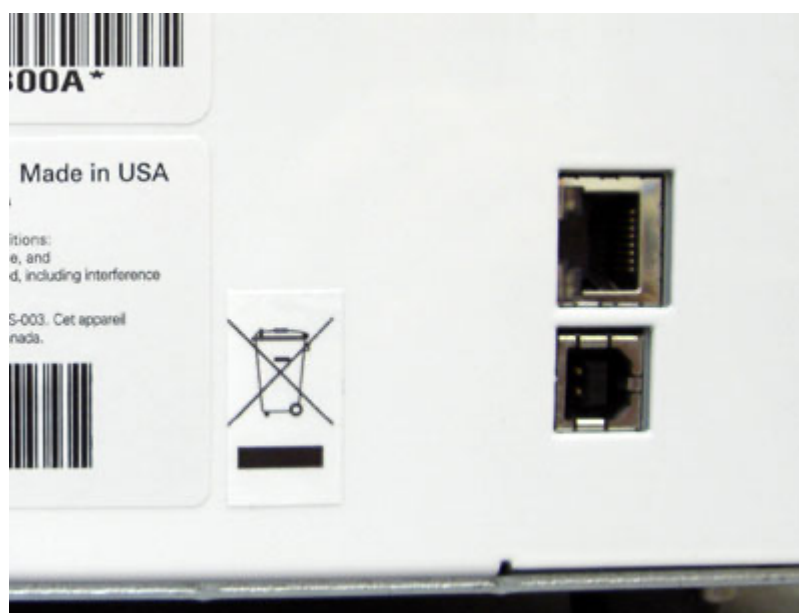
Widok gniazda sieciowego i USB z tyłu drukarki
